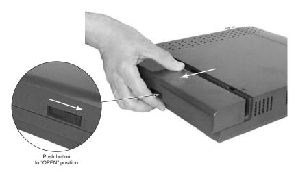
Figure 2: Removing the DS1000 Cover
